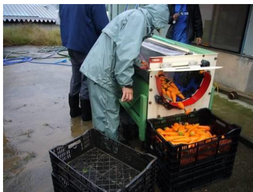
洗浄機での泥落とし作業
